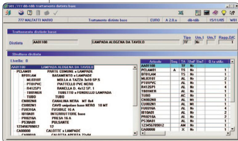
Interrogazione Distinta Base: a sinistra vista ad albero della struttura della distinta, sulla destra dettaglio del componente selezionato
